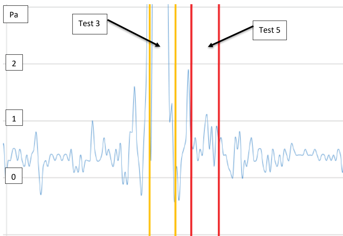
Figur 3: Differenstrykcurve for MP1001 i bryggers. Fremgår også af bilag 3. Test 3 ses mellem de 2 gule streger.
