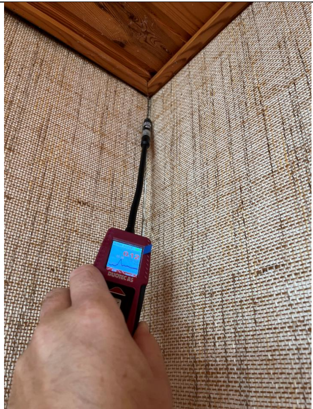
Foto 10: Indtrængning af brint fra forsatsvæg, under loft ved P106.
