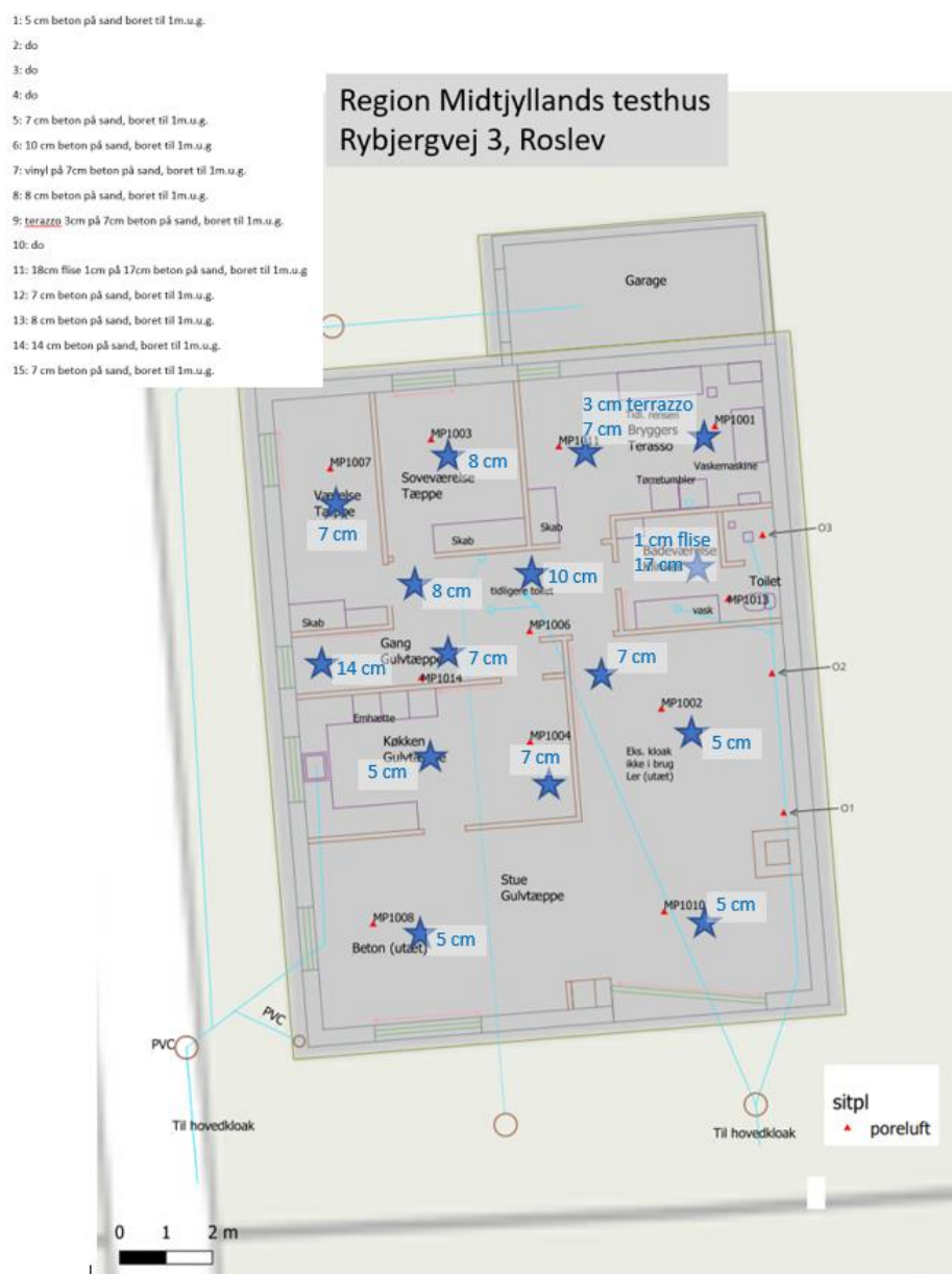
Figur 1: Skitse med gulvopbygning i testhuset.
