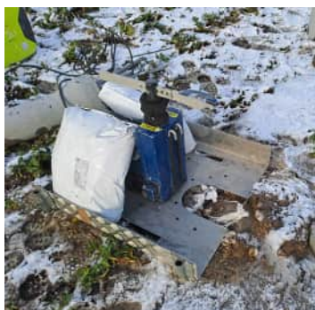
Figur 3.2: Inertipumpe anvendt ved prøvetagningen.
