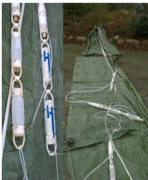
Figur 7.1: Aktuator med to snap samplere og kæde med snap samplere klar til installation i boring /12/.
