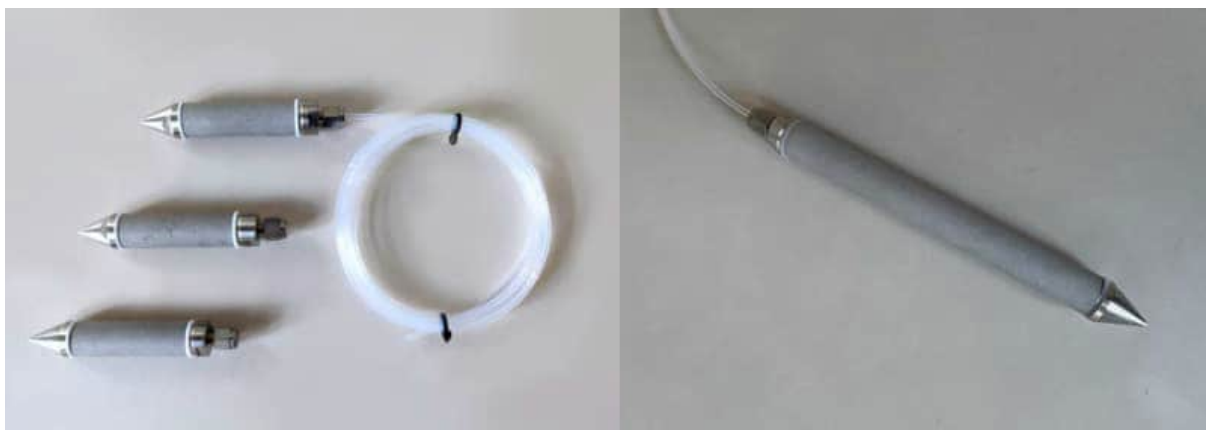
Figur 6.1: Stålsugeceller forhandlet af DMR. Længden af sugecellerne er hhv. 110 mm og 200 mm. Den ydre diameter for begge er 19 +/-0,5 mm. Sugecellerne har et porøst areal på hhv. ca. 40 og 90 cm 2 og en porestørrelse på 0,2-0,5 µm /8/.
