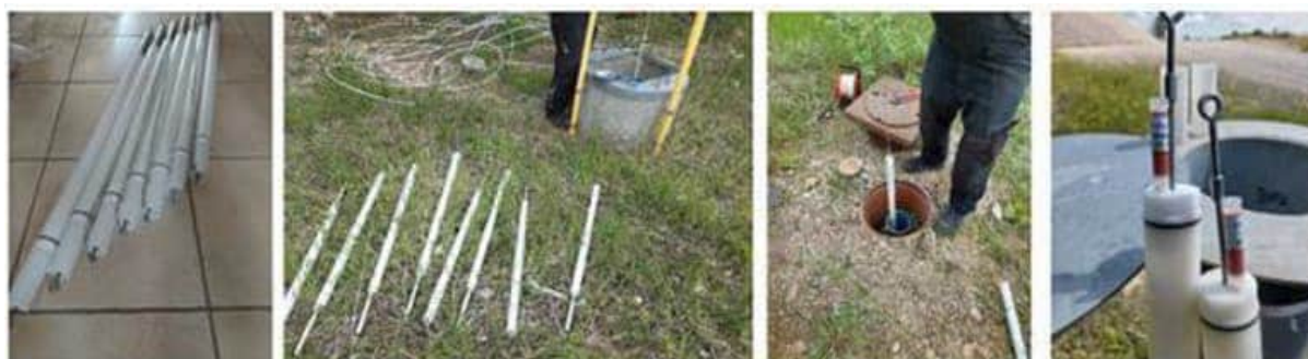
Figur 8.1: Fotos fra samling og montering af Sorbiceller med GWS-40 /10/.
