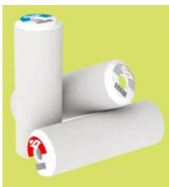
Figur 10.1: Foto af iFLUX måleenhed, som installeres i monitoreringsboringer /16/.
