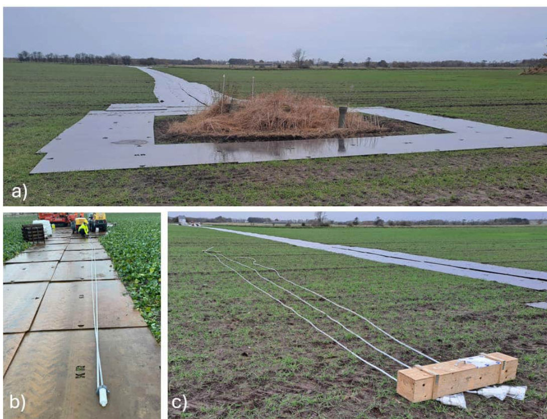
Figur 5.4: a) Udlægning af køreplader omkring testområde. b) klargøring af minifiltre i MF1. c) Klargøring af minifiltre i MF2.
