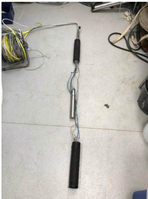
Figur 4.1: MP1-pumpe (i midten) med packere over og under /4/.
