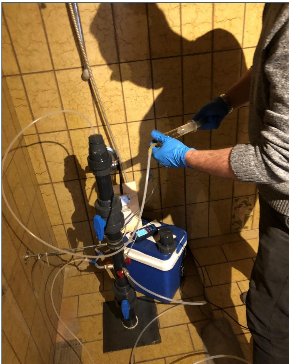
Figur 3.6. Prøvetagning af luft i afløbssystemet bag målepunkt LS1005. Prøven bliver udtaget optil ca. 3 m bag "vandlåsen".
