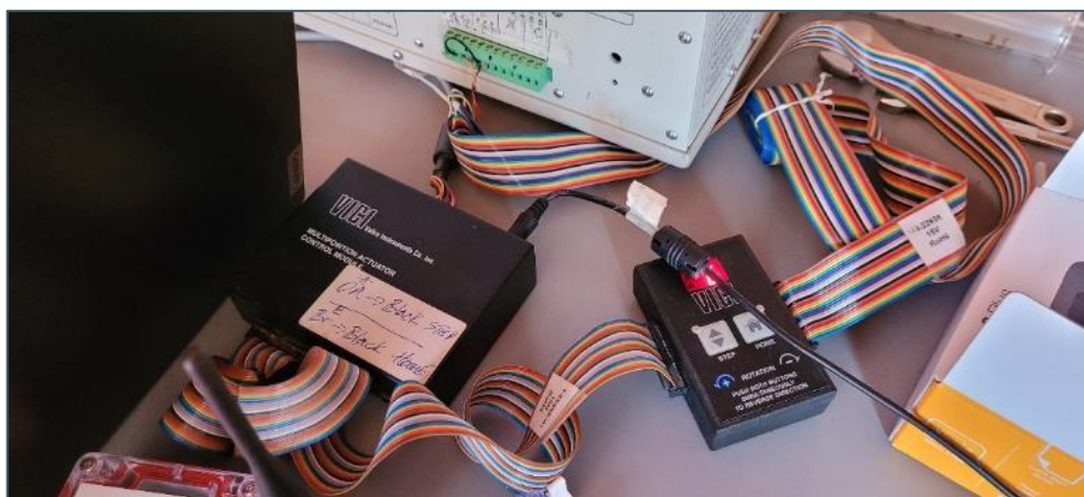
Figur 2.8. Todelt kanalvælger og styringsenhed til manifold.
