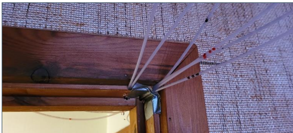
Figur 2.17. Gennemføring af prøvetagningslanger via dørkarme og efterfølgende tætning med tape (endnu ikke gennemført fuldstændigt på dette eksempel).
