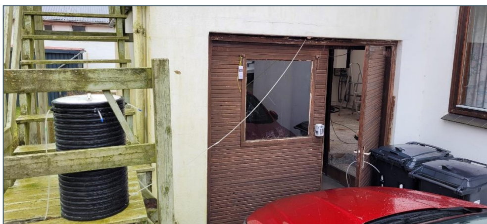
Figur 4.9. Foto set fra udvendig side af carport og ind i bryggers, svarende til den primære udluftsvej for blowerdooren. Yderligere ses 'tryk-absorbent' som den sorte tønde i venstre del af fotoet.
