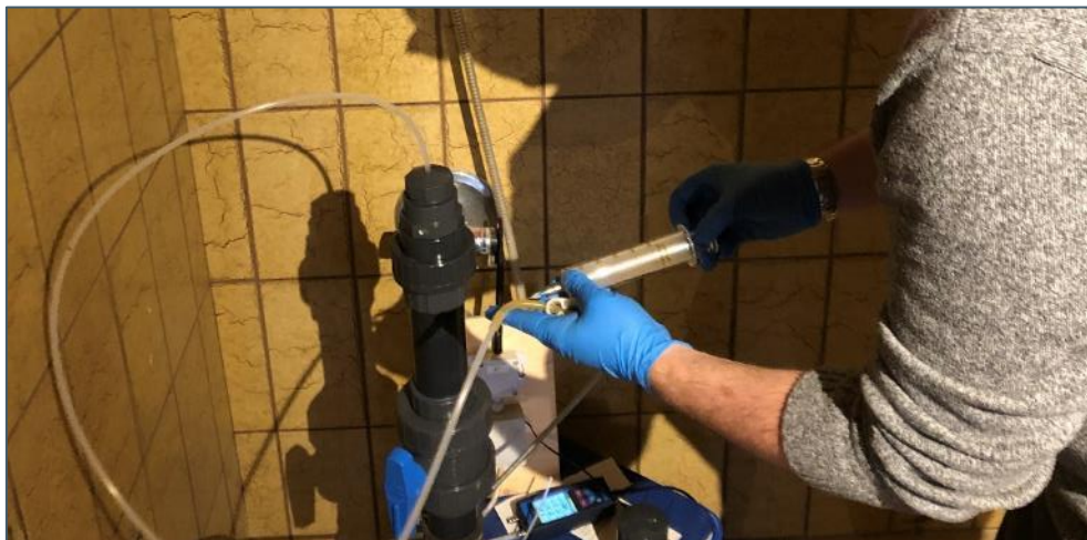
Figur 2.4. Manuel prøveudtagning med 200 ml glassprøjte.
