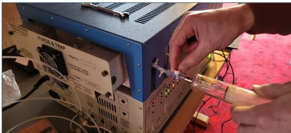
Figur 2.5. Manuel injektion af luftprøve på 25 ml.
