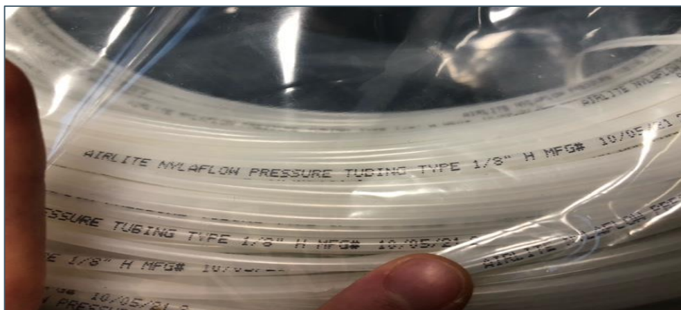
Figur 2.15. Prøvetagningsslange til udlægning mellem prøvepunkt og manifold.
