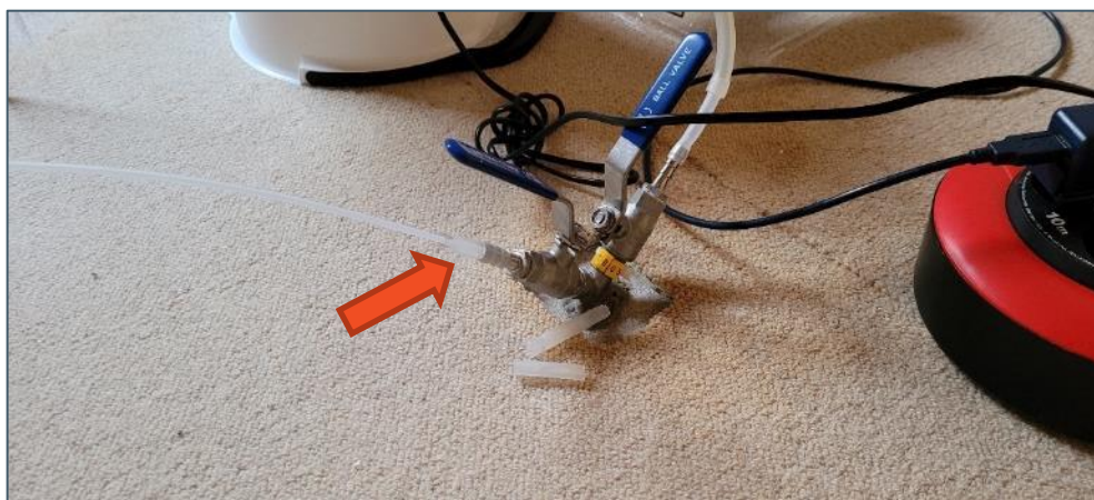
Figur 2.16. Montering af Nylaflow slange med silikone-overgangsstykke på prøvetagningsstuds. Nylaflow slangen er ført hele vejen igennem silikone-overgangsstykket og indvendigt i prøvetagningsstuds (placering markeret med rød pil), så der ikke er kontakt mellem silikonen og luftflowet inde i Nylaflow slangen.
