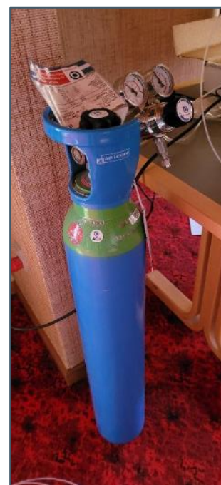
Figur 2.3. 10 liters trykflaske med oxygen og monteret regulator.
