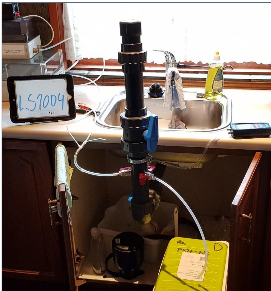
Figur 3.5. Udformning af prøvetagningspunkt LS1004 afløb fra køkkenvask.
