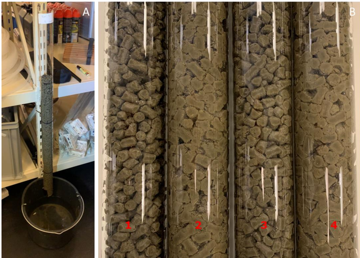
Figur 3: A) Testopstilling for opkvældning af bentonit pellets. B) Visuel fremstilling af bentonit pellets efter tilførsel af vand. 1) Vand hældt igennem pellets 2 gange med 15 min mellemrum. 2) Pellets forbliver vandmættede i 2 gange 15 min. 3) Vand hældt igennem pellets 4 gange med 15 min mellemrum. 4) Vand hældt igennem pellets 8 gange med 15 min mellemrum.
