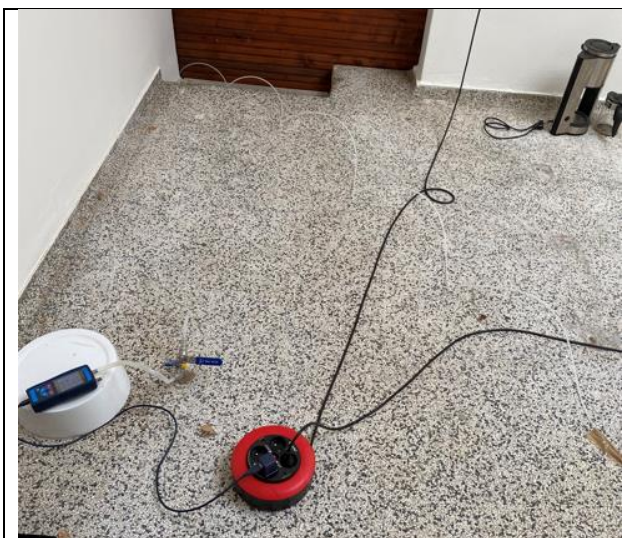
Foto 7: MP1011, som anvendes til injektion ved test 2.
